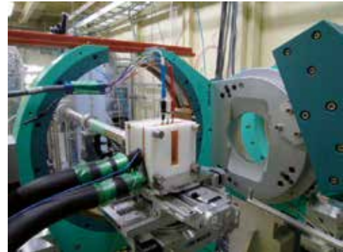
図8 開発した放射光回折用温度制御治具
