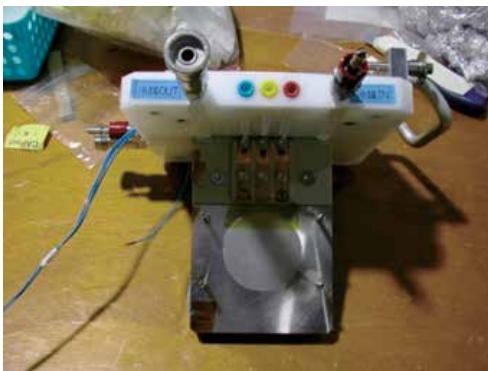
図 2 開発した中性子回折用温度制御治具
